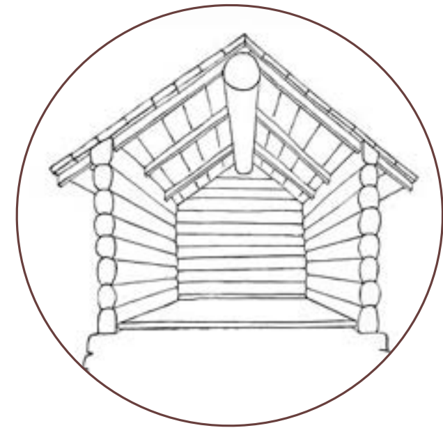
Trønderlånet sin byggeskikk og konstruksjonsprinsippet ligger til grunn for konstruksjonsprinsippet for boligene. Over ser en et gammelt Trønderlån fra Leka Bygdemuseum.
